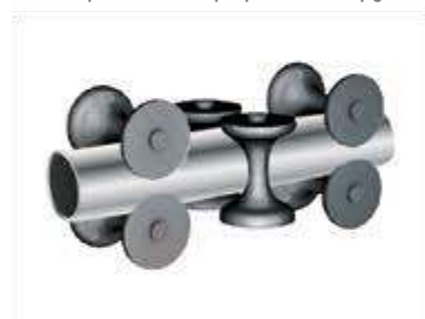
7 Охлаждение, калибровка и правка непрерывной трубы
