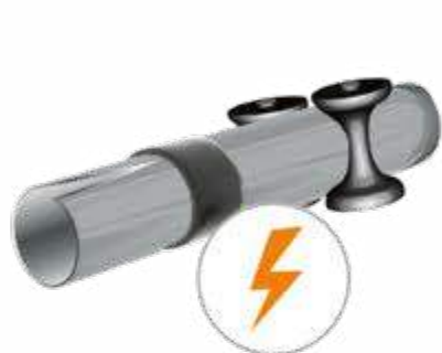
4 Сварка трубной заготовки
