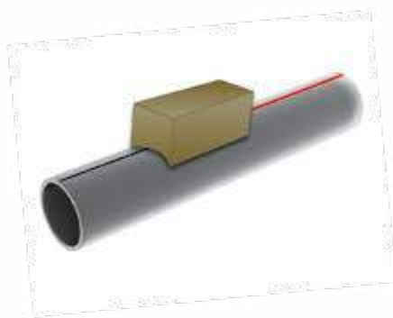
5 Локальная термообработка сварного соединения
