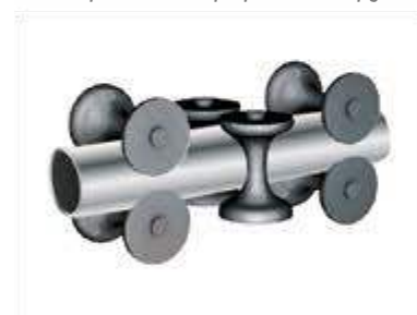
7 Охлаждение, калибровка и правка непрерывной трубы
