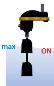
Макс. Уровень запускает насос и ванна опорожняется
