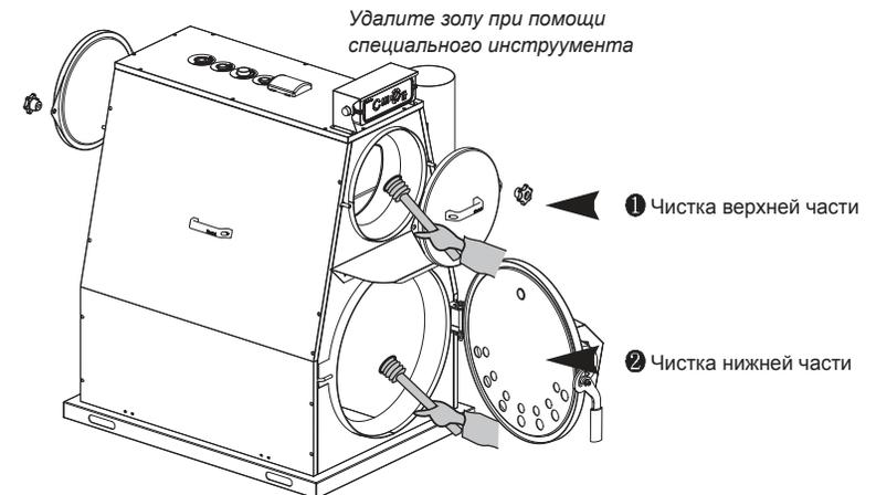
※ **Примечание:** Во время чистки отверстия для чистки, топочной камеры или дымохода отключите вытяжной вентилятор и откройте дверцу.
