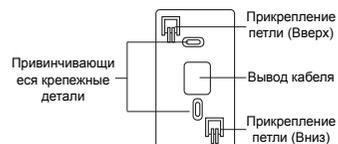
3) Прикрепите термометр (CTR-6070), прижав их к стене таким образом, чтобы подвесная часть совпала с крепежной петлей, и потяните его вниз.
