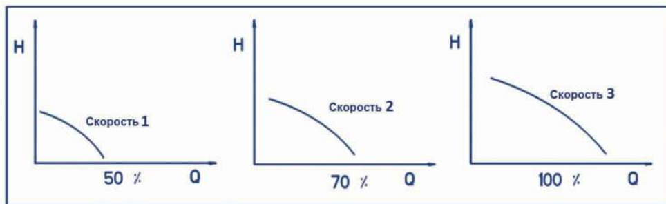
Рисунок 9. Характеристики насоса при работе на разных скоростях
