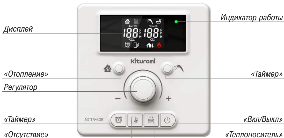
Рисунок 9. Обозначение кнопок управления NCTR-60R.
