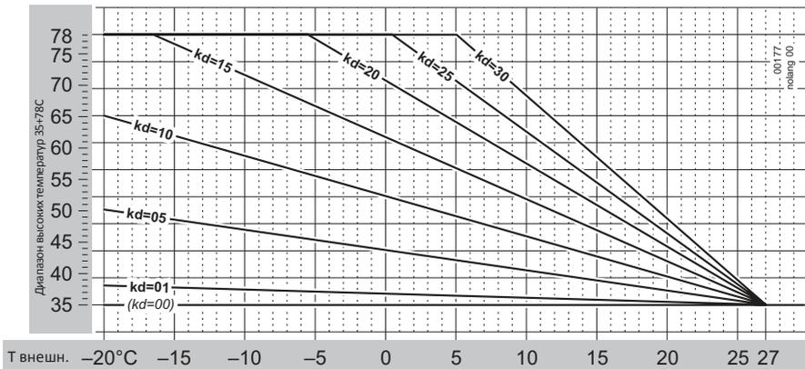
На практике, значение **kd** регулируется в зависимости от расчетного качества термической изоляции помещения. Диапазон его регулирования будет от 01 до 30: более высокие значения используются в случае высокой термической дисперсии и менее эффективной изоляции и наоборот.
