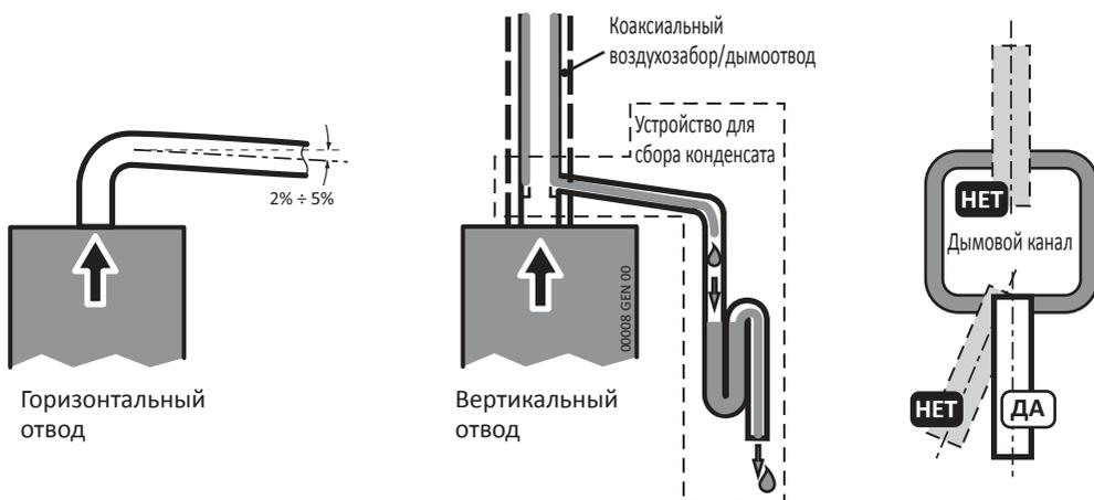
На **вертикальных участках** отводного канала, для того чтобы избежать застоя конденсата и его возврата в камеру сгорания, **необходимо использование специального комплекта для сбора конденсата**.
