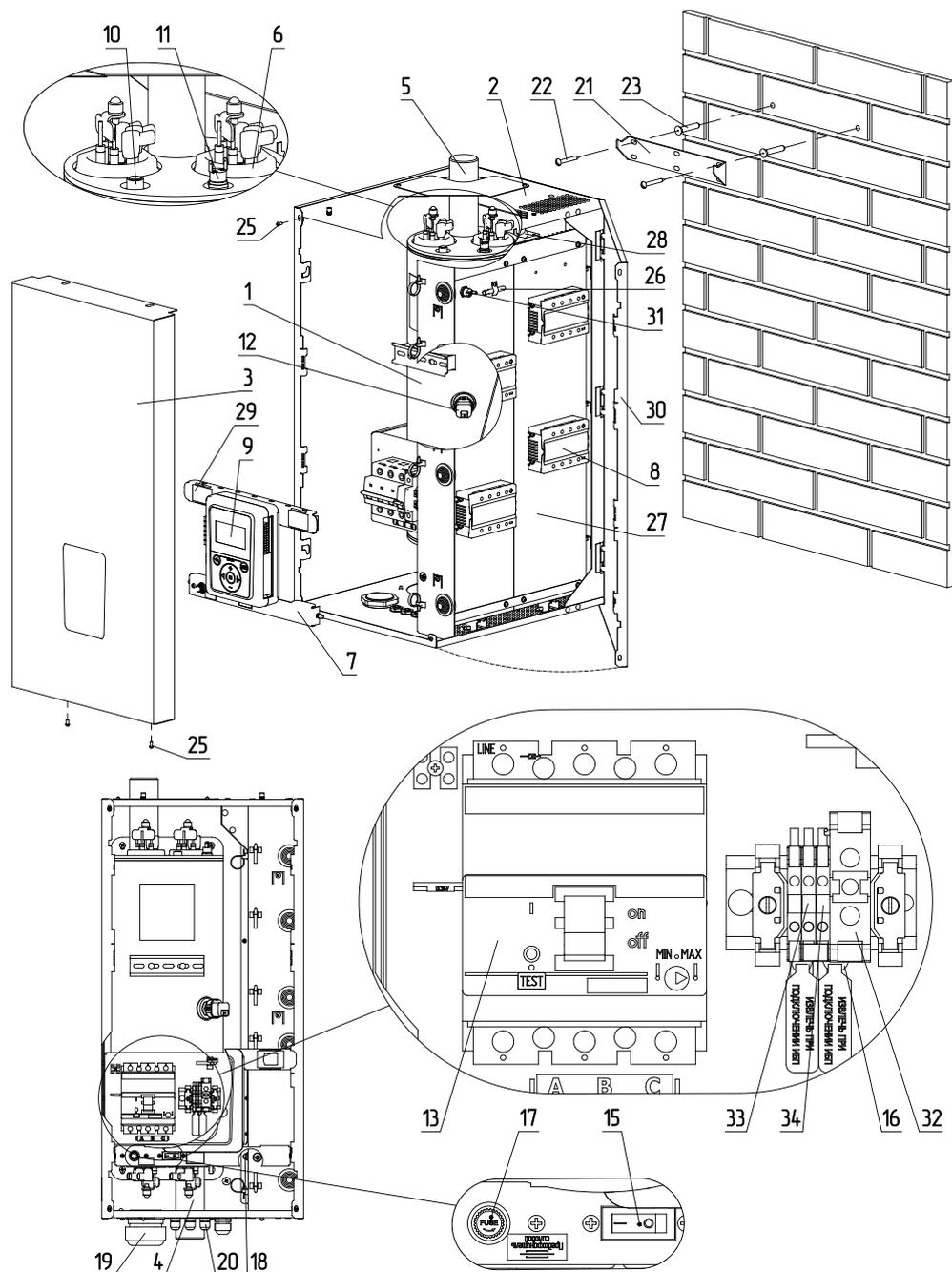
Рис.4 Устройство электрического котла ZOTA SOLID-X 48-60 кВт
