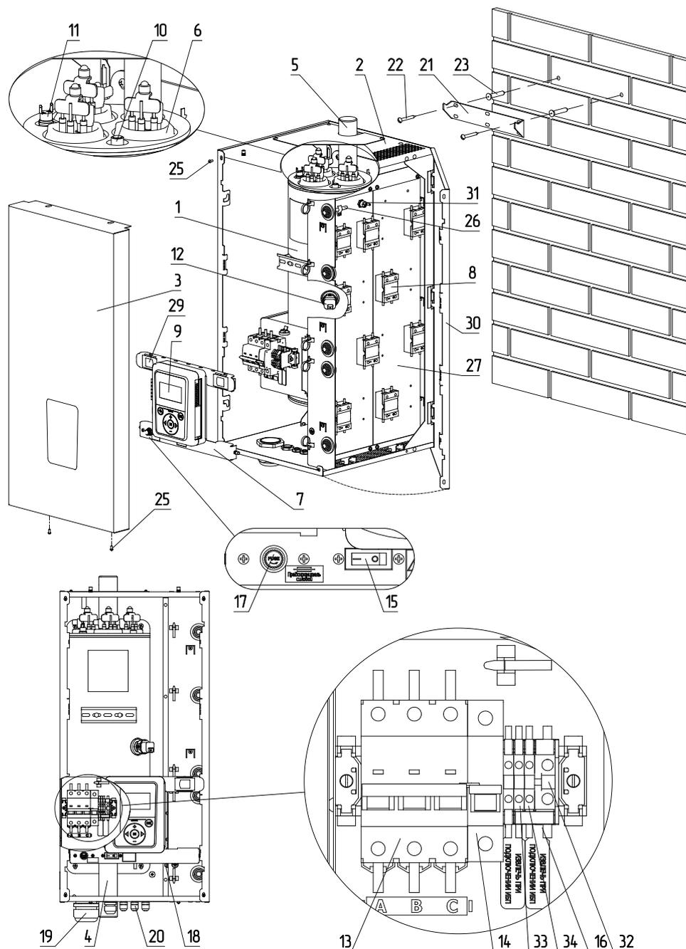
**Рис.3 Устройство электрического котла ZOTA SOLID-X 30-42 кВт**
