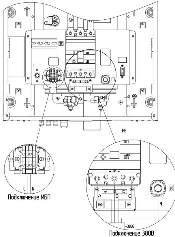
**Рис.9** Схема подключения электрического котла ZOTA SOLID-X 72-133 кВт
