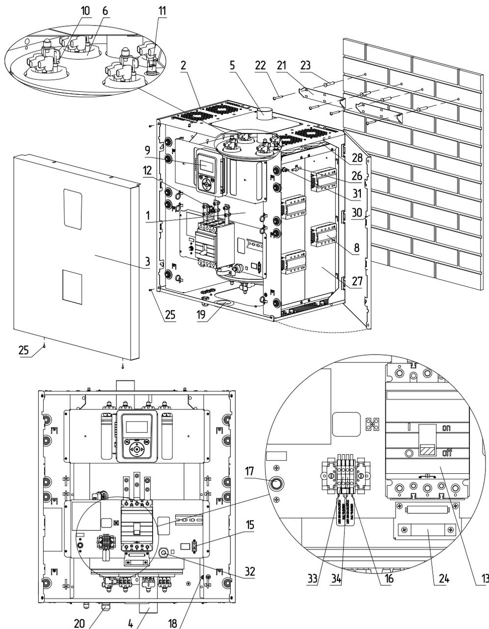
Рис.6 Устройство электрического котла ZOTA SOLID-X 133 кВт
