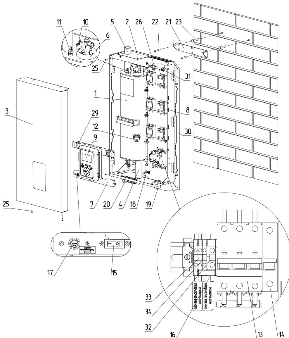
Рис.2 Устройство электрического котла ZOTA SOLID-X 12-24 кВт
