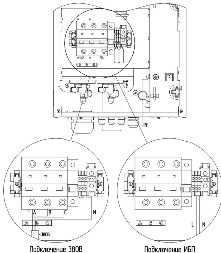
**Рис.8** Схема подключения электрического котла ZOTA SOLID-X 30-60 кВт
