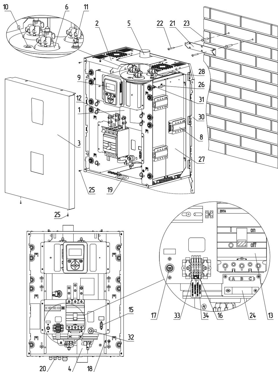
Рис.5 Устройство электрического котла ZOTA SOLID-X 72-100 кВт
