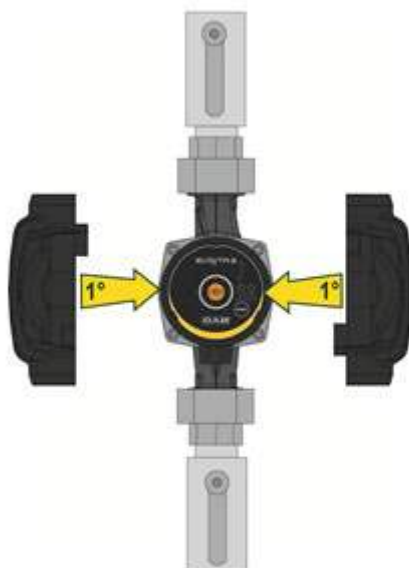
Фигура 7: Изолация на корпуса на помпата
