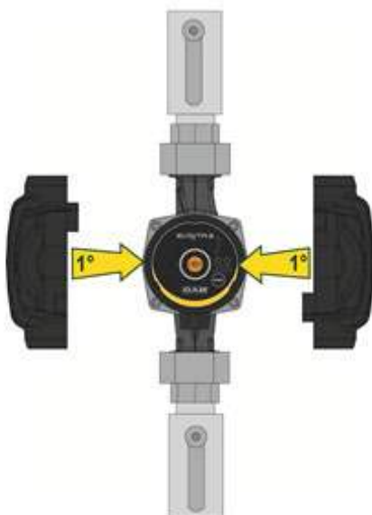
7. ábra: A pumpatest elszigetelése
