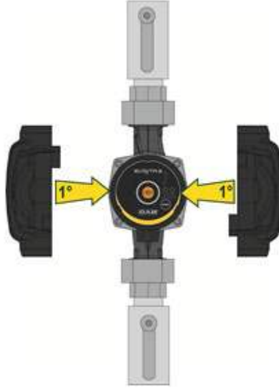
Resim 7: Pompa gövdesinin yalıtımı
