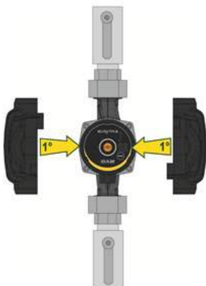
Afbeelding 7: Isolatie van het pomphuis
