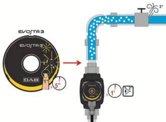
Figura 7: Purga automática de la bomba
