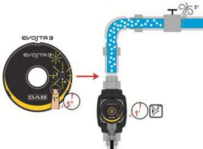
Image 9: Purge automatique de la pompe
