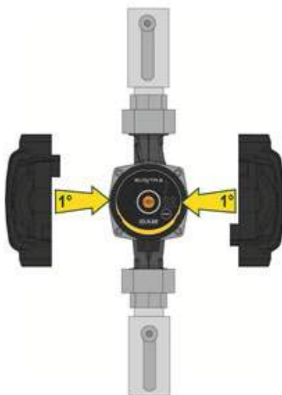
Fig 7: Isolering av pumphuset
