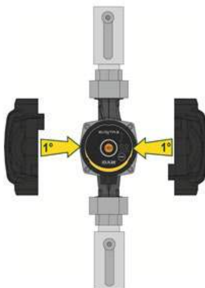
Figura 5: Aislamiento del cuerpo de la bomba
