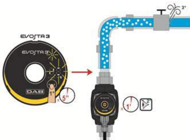
Фигура 9: Автоматично обезвъздушаване на помпата
