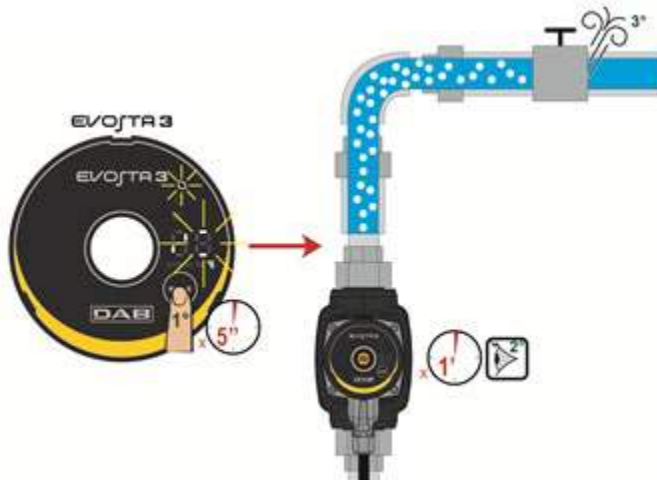
Fig. 9: Automatisk udluftning af pumpe
