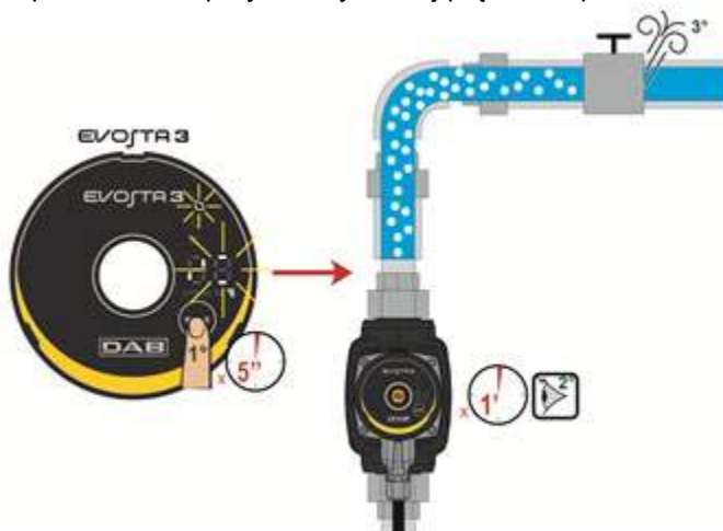
Rysunek 9: Automatyczne odgazowanie pompy
