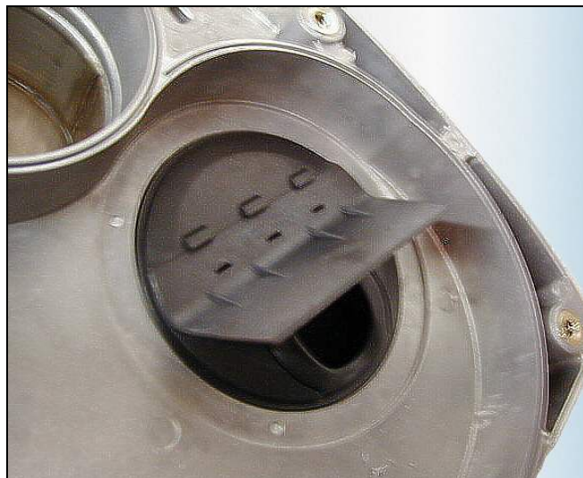
Рис. 5: Воздухозаборник с углом для GE1.40H > 25 кВт и для GE1.65H от 45-70 кВт.
