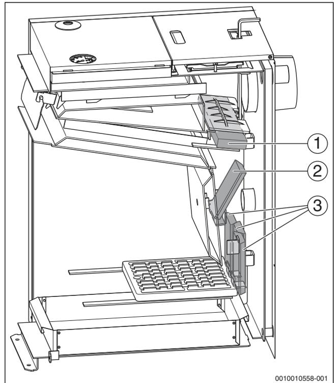
Рис. 18 Положение камней в топочной камере (вид сбоку)
