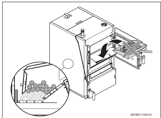
Рис. 11 Загрузка небольшого количества топлива
