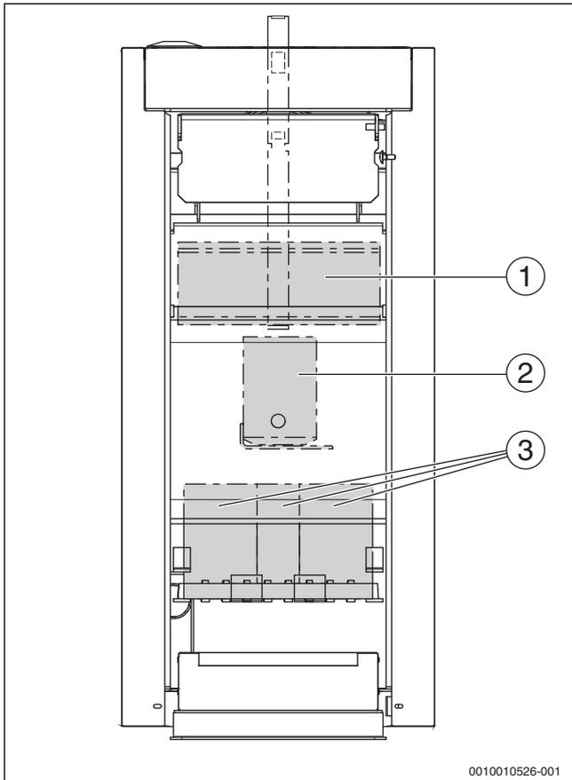
Рис. 17 Положение камней в топочной камере (вид спереди)
