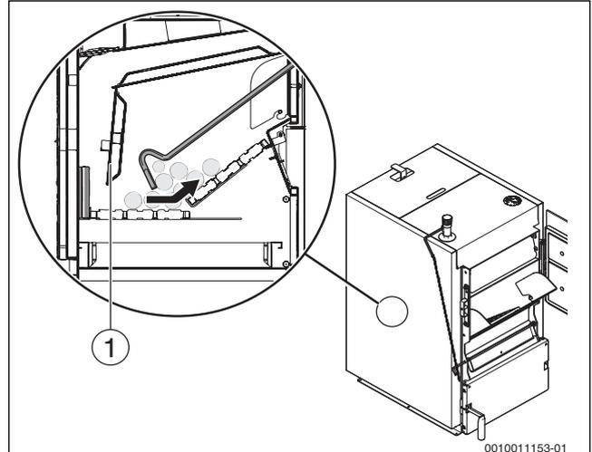
Рис. 9 Ворошите угли и очищайте пространство под пластиной
