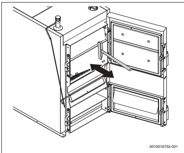
Рис. 15 Очистите скребком стенки топочной камеры.
