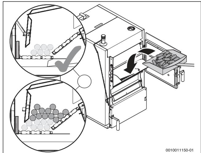
Рис. 10 Загрузка топлива на угли в котле
