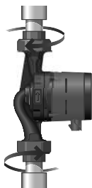
Рис. 3 Монтаж насоса ALPHA3
