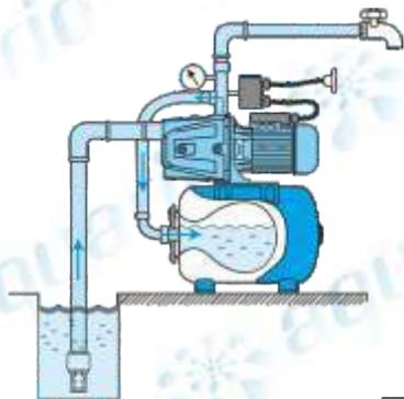
**Рис.12** После успешного запуска можно перекрыть воду на выходе из напорной магистрали.
