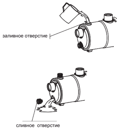
Рис. 5 Перед первым запуском корпус насоса необходимо заполнить водой
