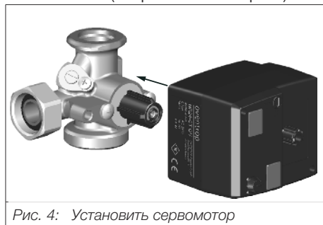
Рис. 6: Монтаж на 3-ходовой смесительный вентиль.
