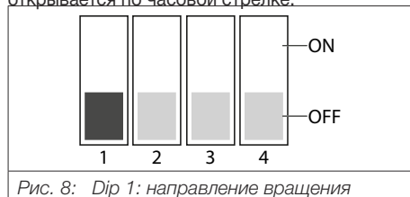
Рис. 8: Dip 1: направление вращения
