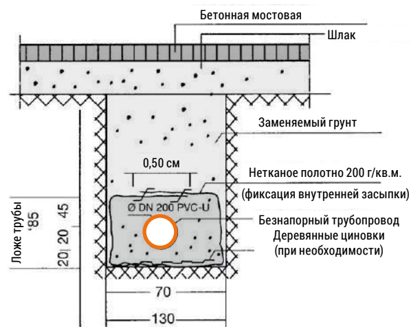
РИС. 7. ПРИМЕР ПРОКЛАДКИ ТРУБ В МЯГКОМ ГРУНТЕ
