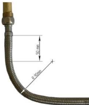
Рис. 4 Требования к монтажу гибких шлангов
