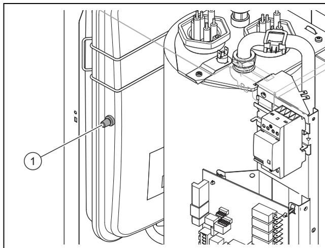
8. Перед заполнением системы отопления измерьте давление на входе расширительного бака при отсутствии давления в отопительном приборе на штуцере для проведения измерений (1). расширительного бака.
