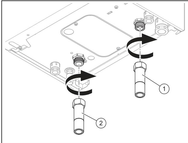
1. Присоедините трубопровод подающей линии системы отопления (1), к патрубку подающей линии системы отопления.
