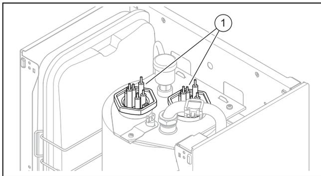
1. Отсоедините провода, идущие от ТЭНов (1), к электронной плате и колодке подключения к сети (N, синий).
