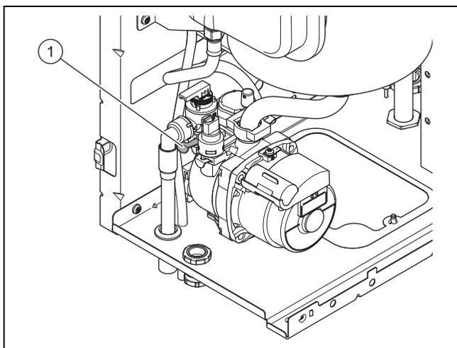
1. Снимите стопорную скобу (1), и извлеките предохранительный клапан из изделия.
