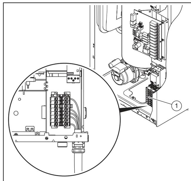
1. Смонтируйте прилагаемый кабельный ввод для кабеля (1), подключения к электросети.
