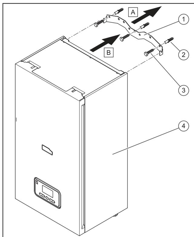
1. Приложите планку для крепления прибора (1) к стене и отметьте три отверстия.
