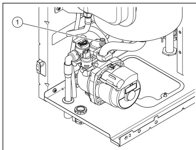
1. Открутите колпачок быстродействующего воздухоотводчика (1), на насосе на один-два оборота.
