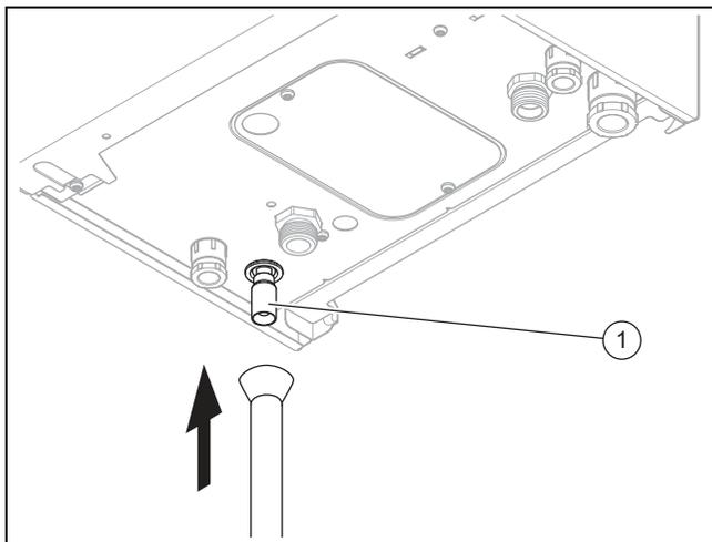
1. С помощью заливной воронки присоедините сливной трубопровод к сливу (1), предохранительного клапана.
