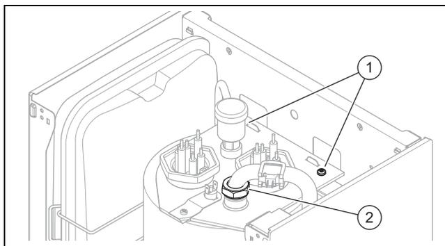
5. Выверните крепёжный винт (2), обратной линии системы отопления на верхней стороне теплообменника.
