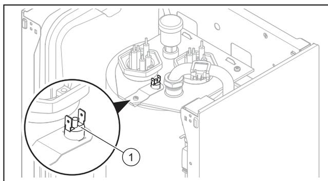
1. Отсоедините оба разъема от предохранительного ограничителя температуры (1)..
