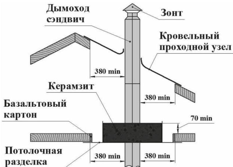
Рисунок 6 — Требования безопасности при прохождении дымовой трубы через межэтажные перекрытия и кровлю
