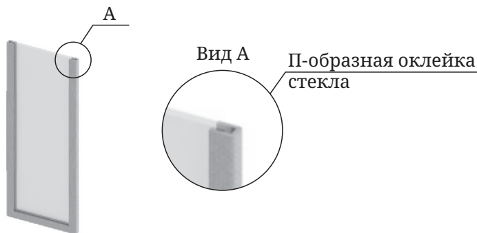
Рисунок 9. П-образная оклейка бокового стекла
