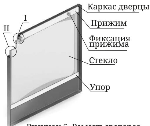
Рисунок 5. Ремонт светопрозрачного экрана дверцы
