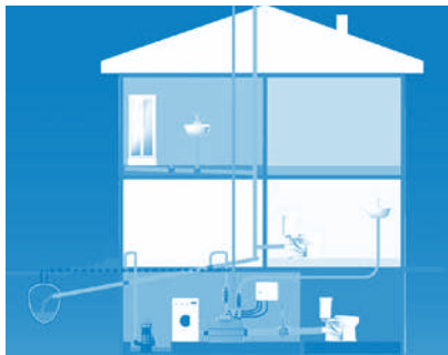
Figura 1: Esempio di installazione con pompa sommergibile:
