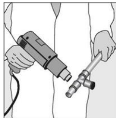
Нагрев демонтируемого соединения
