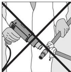
Недопустимо! Нагрев соединения без отсоединения от сети.
