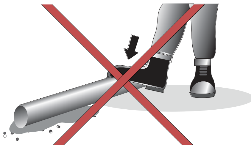
Трубы не следует складировать на основаниях с острыми кромками
