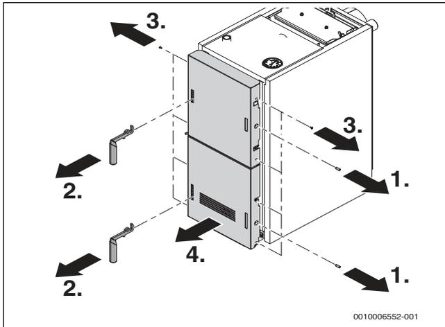
Рис. 10 Снятие облицовки двери
