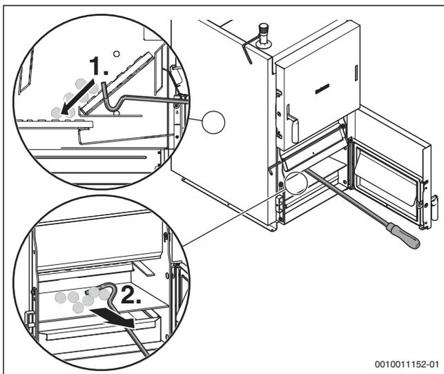
Рис. 38 Чистка решёток через дверь топочной камеры
