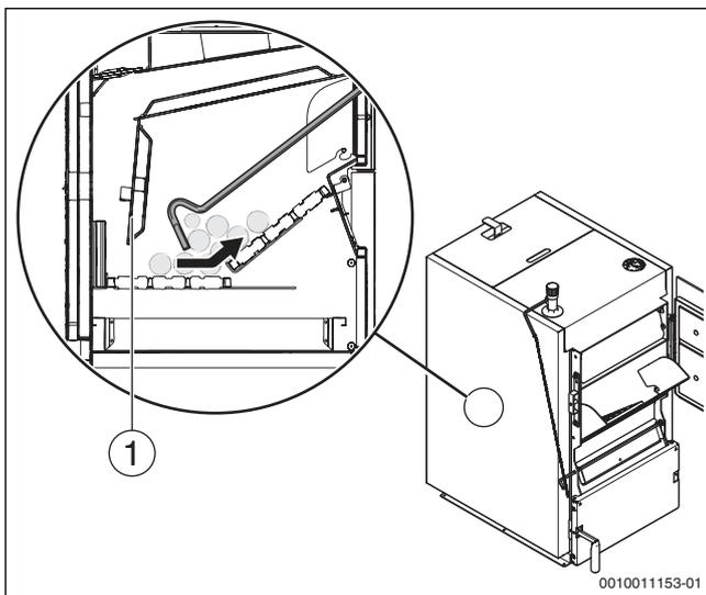
Рис. 39 Воршите угли и очищайте пространство под пластиной
