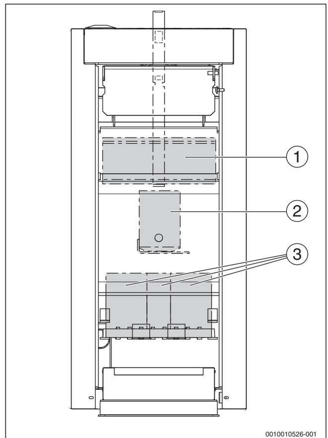
Рис. 33 Положение камней в топочной камере (вид спереди)
