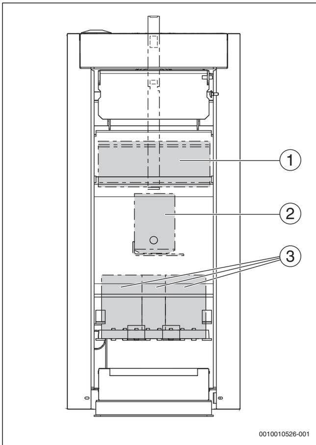
Рис. 21 Положение камней в топке (вид спереди)
