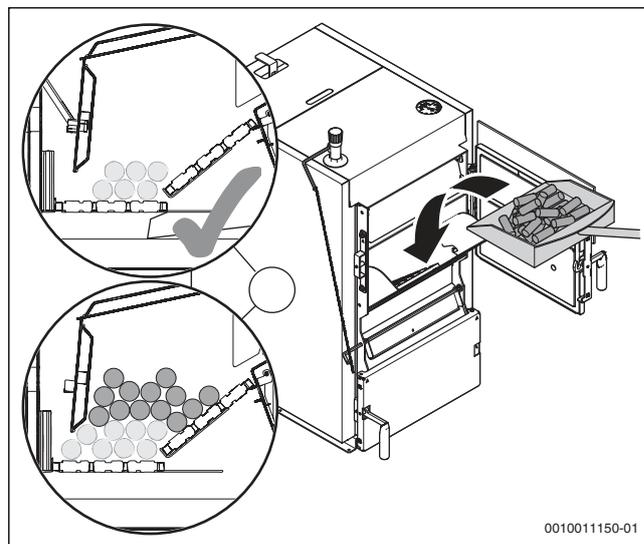
Рис. 40 Загрузка топлива на угли в котле
