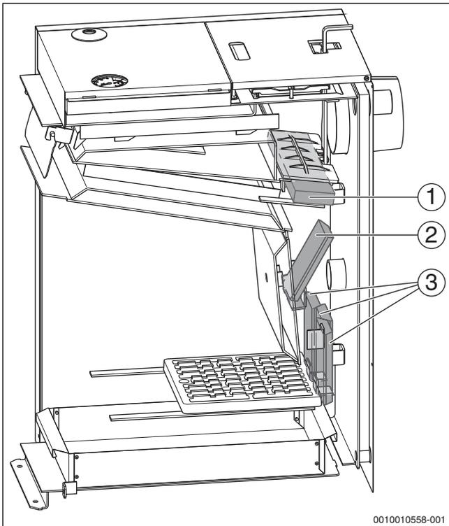
Рис. 34 Положение камней в топочной камере (вид сбоку)
