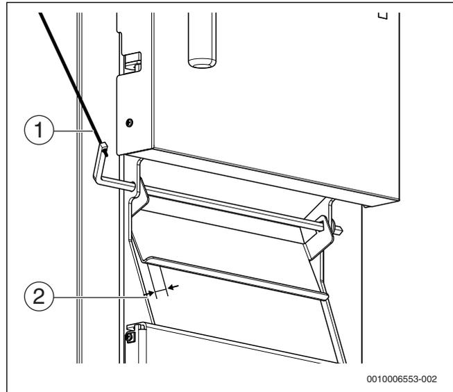
Рис. 24 Регулировка натяжения цепи
