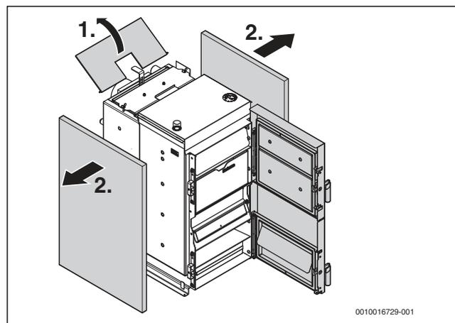
Рис. 8 Снимите крышку коллектора дымовых газов
