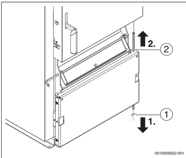
Рис. 11 Снимите фиксатор и выньте шарнирную ось
