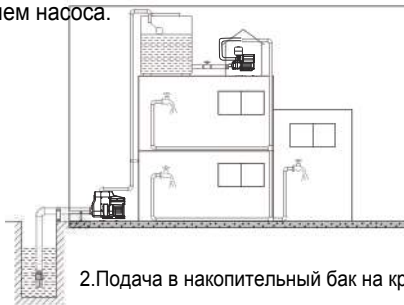
Примеры установки: 1. Непрямая подача из бака
