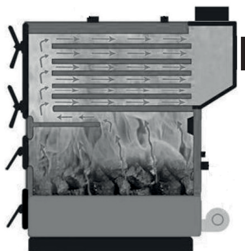
Рис. 5. Схема движения дымовых газов в трехходовом теплообменнике для котла VLK SRK-130-1500.
